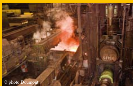
Les brames sont ensuite laminées (réchauffées et mises à bonne dimension : épaisseur, longueur et largeur).
