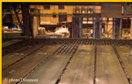
Les tôles sont ensuite marquées et prêtes pour les derniers traitements selon les désirs des clients.
