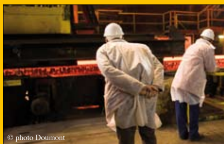
La poche est ensuite versée dans la « coulée continue ». Il en sort une brame qui est mise à dimension (en longueur)
