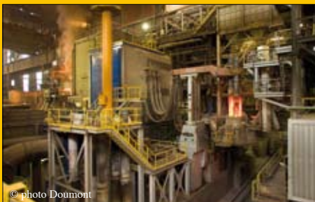
La ferraille est versée dans le four électrique à fusion. L'énergie thermique nécessaire est produite par 3 électrodes.
